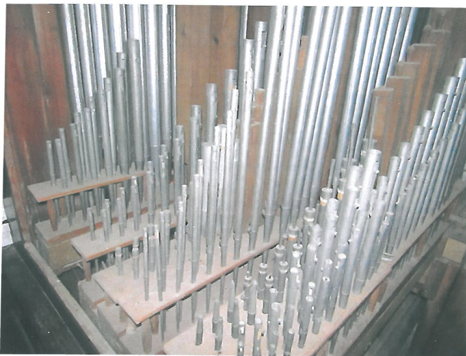
Fot 3. Widok wewnątrz organów - aparat brzmienia (sekcja manuału)
