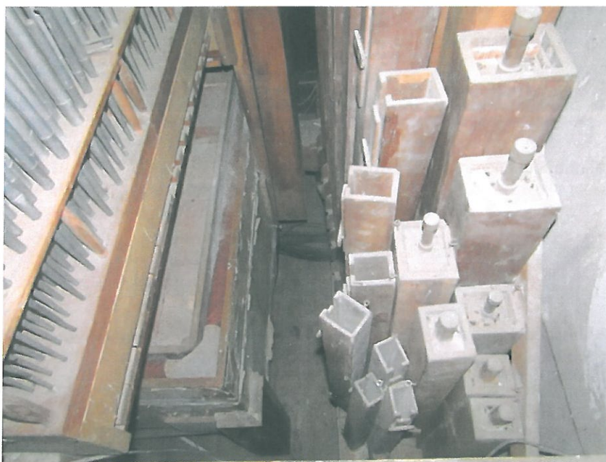
Fot 4. Wnętrze organów - aparat brzmienia (sekcja pedału i miech)
